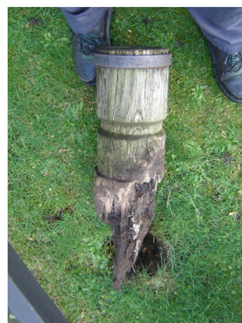
Gebroken kruipaal als gevolg van inrottingen.
