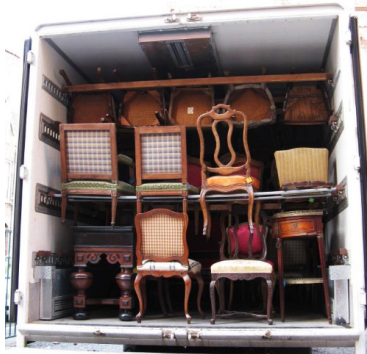
Mobiele warmtekamer voor de behandeling van verplaats- of demonteerbare onderdelen.
